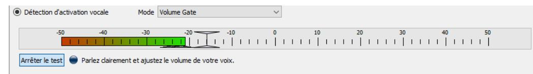
Le bouton bleu doit s'éclairer uniquement pendant l'émission d'un seuil convenable de détection vocal. Lorsque les
