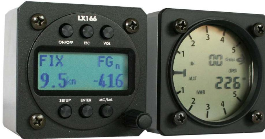
Le Vario ne comporte aucun traitement et est uniquement périphérique de la centrale LX\_166. La centrale LX 166 dispose d'un commutateur rotatif et de 6 boutons poussoirs, et d'un écran d'affichage.
